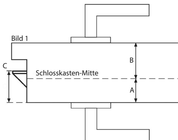
A = Abstand von Mitte Schlossnuss (= Zylinderhalteschraube) bis Türblattschließfläche (Futterseite)
